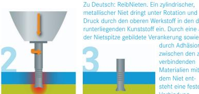
Druck durch den oberen Werkstoff in den darunterliegenden Kunststoff ein. Durch eine an der Nietspitze gebildete Verankerung sowie durch Adhäsion
